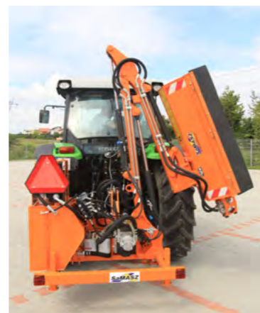
Transportstellung - sichtbare Heckstoßstange mit Beleuchtung.
